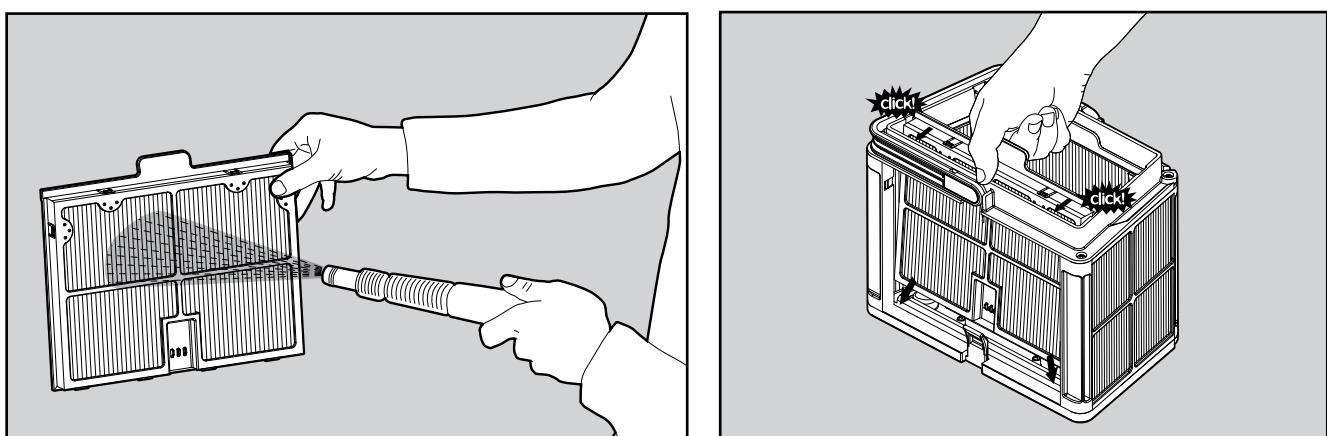
6.2.2 Промойте стенки фильтра водой из шланга.
