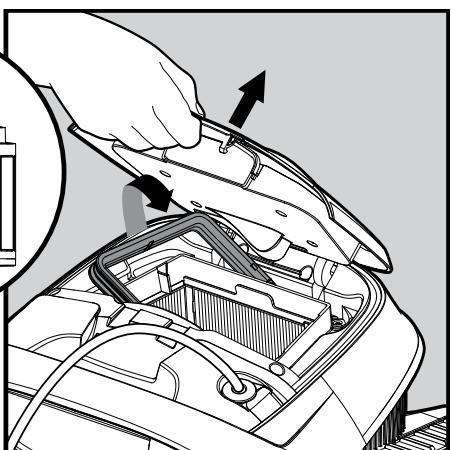
6.1.2 При открытии крышки фильтра, ручка автоматически поднимается.
