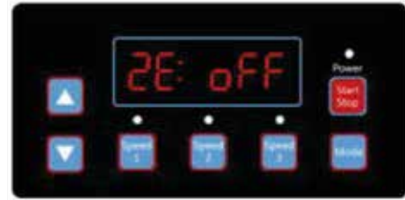
Рисунок 4.19, График работы 2 Вкл/Выкл, по умолчанию Выкл.
