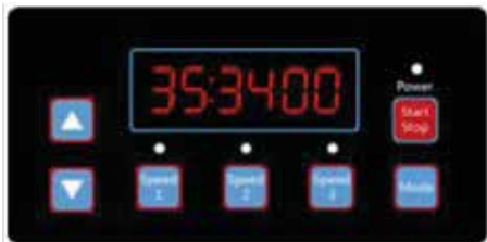
Рисунок 4.20, График работы 3 Скорость, по умолчанию 3400 об/мин
