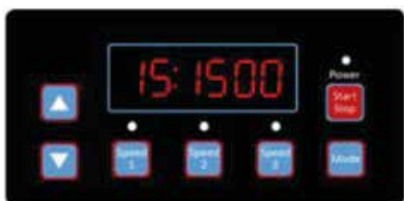
Рисунок 4.12, График работы 1 Скорость, по умолчанию 1500 об/мин
