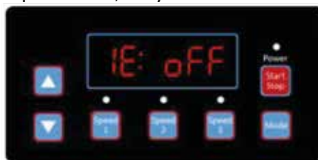
Рисунок 4.15, График работы 1 Вкл/Выкл, по умолчанию Выкл.
