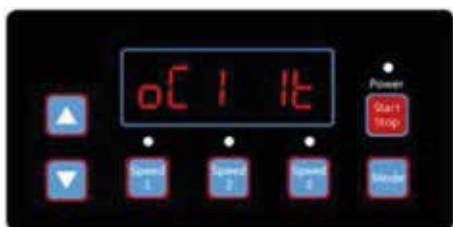
Рисунок 4.25, Автовосстановление, детали ошибки OC1, время ошибки 1
