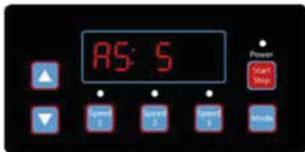
Рисунок 4.27, Обратный отсчет автозапуска, осталось 5 секунд
