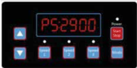
Рисунок 4.22, Скорость самозаполнения, по умолчанию 2900 об/мин
