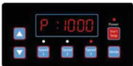
Рисунок 4.9, Дисплей энергопотребления, Скорость 3
