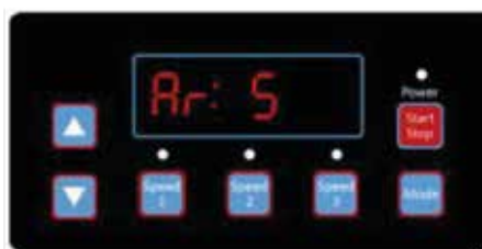
Рисунок 4.26, Обратный отсчет автовосстановления, осталось 5 секунд
