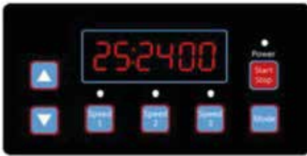
Рисунок 4.16, График работы 2 Скорость, по умолчанию 2400 об/мин
