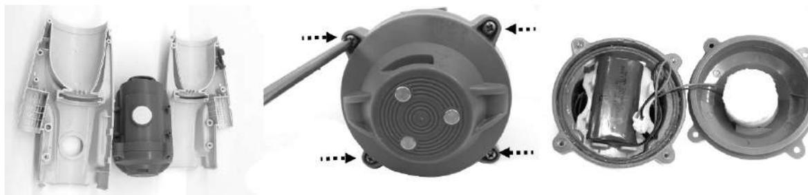
4. Выньте аккумулятор из основной камеры. Чтобы отсоединить батарею, нажмите зажим на коннекторе и достаньте ее. ПРИМЕЧАНИЕ. Немедленно оберните коннектор изоляционной лентой, чтобы избежать короткого замыкания, вызванного контактом обеих клемм.
