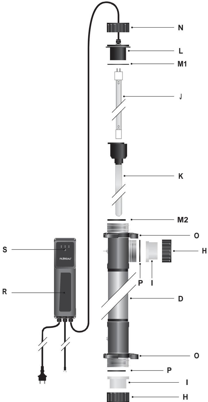
Filtreau UV-C Titan забезпечує кристально чисту воду. Витончений дизайн і високоякісний матеріал виробляє високе УФ-С випромінювання з довжиною хвилі точно 253.7nm. Такий високий рівень радіації вбиває майже всі бактерії, віруси і навіть гриби, забезпечуючи чітку і чисту воду. В результаті, рівень доданих хімічних речовин (наприклад, хлор), може бути зменшений до 80%, що забезпечує більш природну, більш здорову воду!
